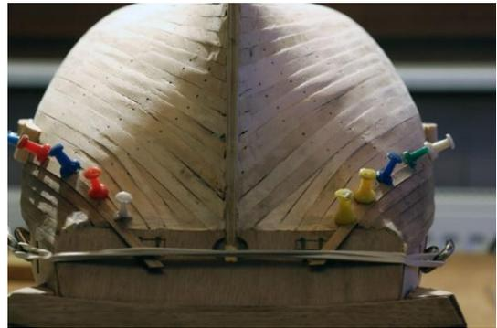
Abbildung 66: Fixierung der Planken am Heck zum Spiegel (15.12.2020)
