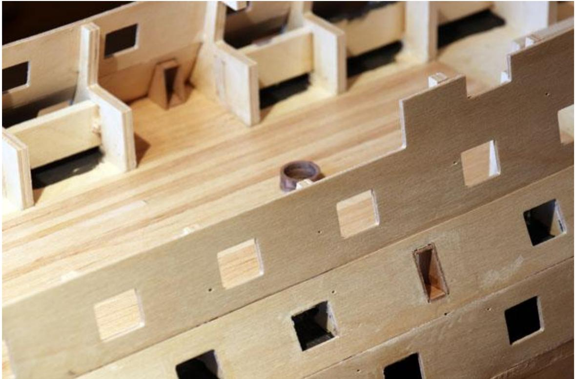
Abbildung 64: mittlere Batteriedeck komplett (11.12.2020)
