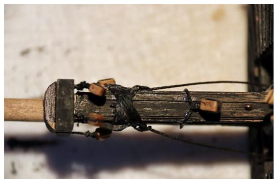
Abbildung 562: Blöcke am Fockmast-Eselshaupt (13.12.2024)
