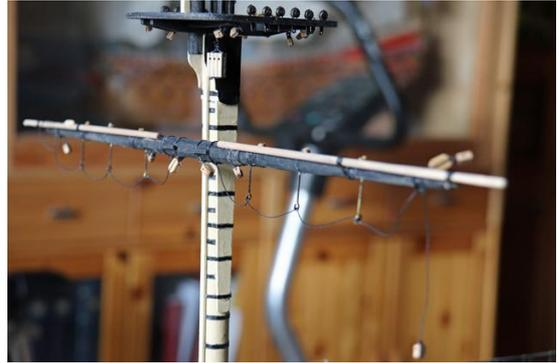
Abbildung 489: Fockrah mit Fußsperde komplett
