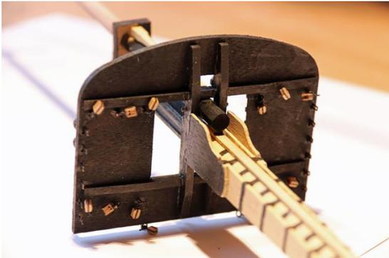
Abbildung 422: Untermast mit Wulginge und Kalben- (05.12.2024)
