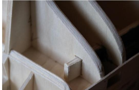
Abbildung 38: Abschrägung Heck, Detail (01.06.2020)
