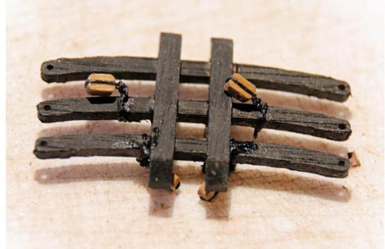
Abbildung 419: Vorstenge-Längssalinge und Quersalinge unten (30.11.2024)
