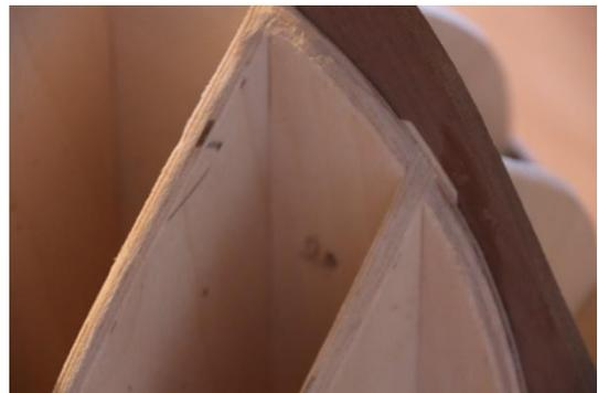
Abbildung 40: Abschrägung Bug, Detail (01.06.2020)
