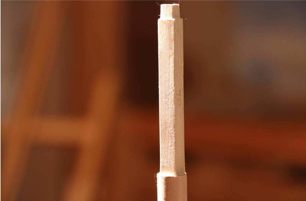
Abbildung 408: Unterer Fockmast mit 8mm und 6 mm Quadrat (22.11.2024)
