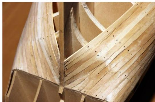
Abbildung 42: Heckbeplankung (27.11.2020)
