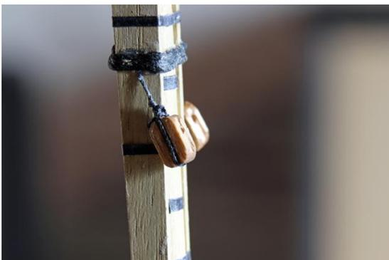
Abbildung 567: Seitliche Blöcke am Großmast (01.03.2025)
