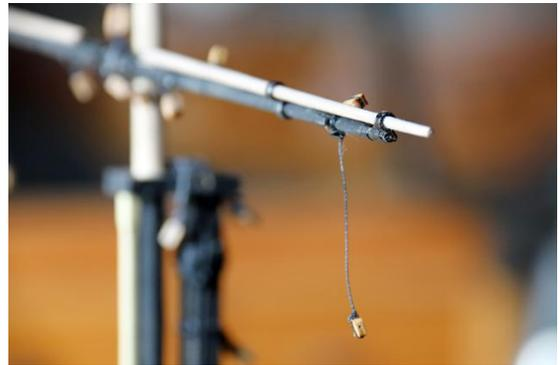
Abbildung 497: Fockmarsrah mit Blöcke, Detailansicht (22.03.2025)
