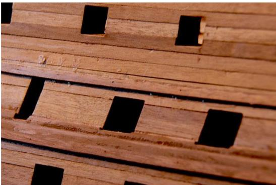
Abbildung 97: Montage der 1. Leiste des oberen Barkholzes (19.01.2021)
