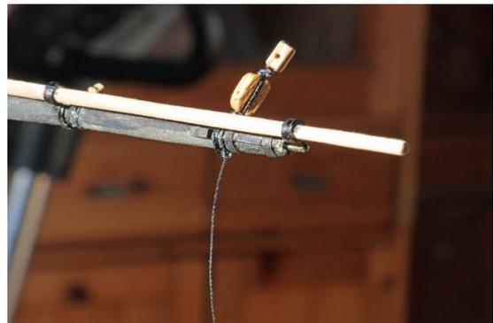
Abbildung 485: Fockrah mit Blöcke, Detailansicht (13.03.2025)
