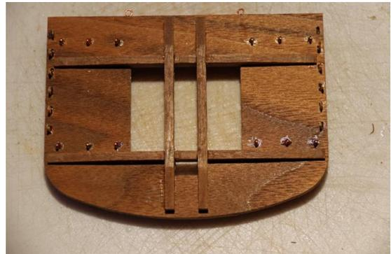
Abbildung 412: Quer- und Längssalinge (27.11.2024)
