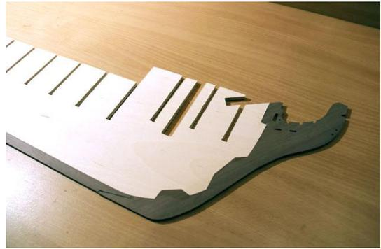
Abbildung 13: Kiel mit angeklebten Steven und vordere Kielschwein (01.05.2020)
