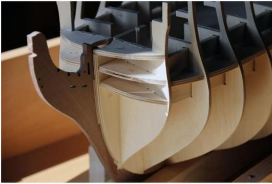
Abbildung 22: Bugstützen und Plankenenden Batteriedeck (05.05.2020)
