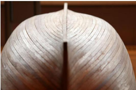
Abbildung 71: Beplankung bis zum Kiel (28.12.2020)
