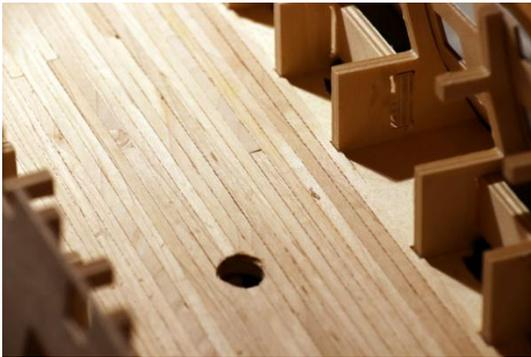
Abbildung 59: Beplankung mittlere Batteriedeck (09.12.2020)
