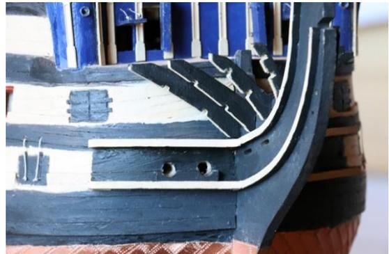
Abbildung 275: Montierte Auflanger (04.04.2023)
