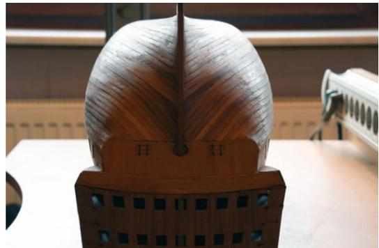
Abbildung 72: Beplankung mit Kielschwein und Achtersteven (28.12.2020)
