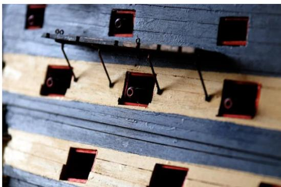
Abbildung 338: Montierte Heckrüste mit Püttingseisen (03.07.2023)
