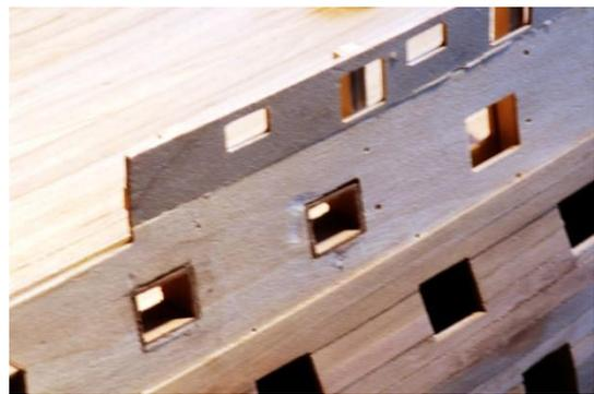
Abbildung 83: Stückpfortenverkleidung plangeschliffen (06.01.2021)
