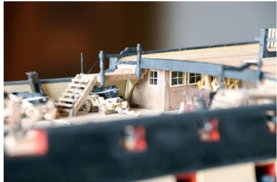
Abbildung 309: montierte Poopdeckleiter (31.05.2023)
