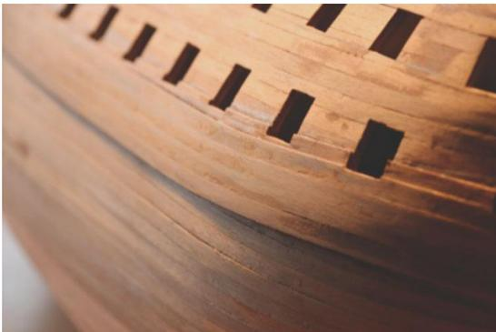
Abbildung 91: Fertiges unteres Barkholz (18.01.2021)
