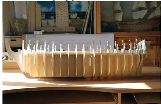
Abbildung 17: Kiel mit Spannten und Batteriedeck (04.05.2020)
