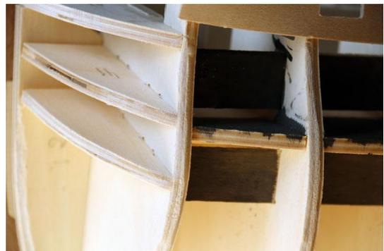
Abbildung 29: Schwarze Rohrattapenstreifen und abgeschrägte Schotten 1 und 2 (11.05.2020)
