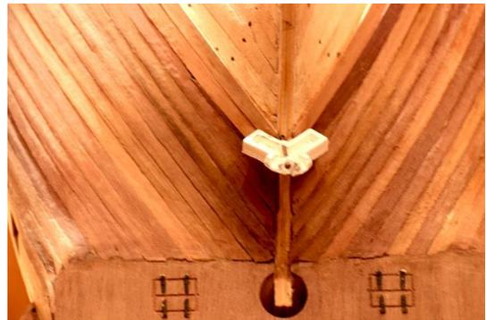
Abbildung 68: Fixierung der Planken am Achtersteven im weiteren Verlauf (21.12.2020)
