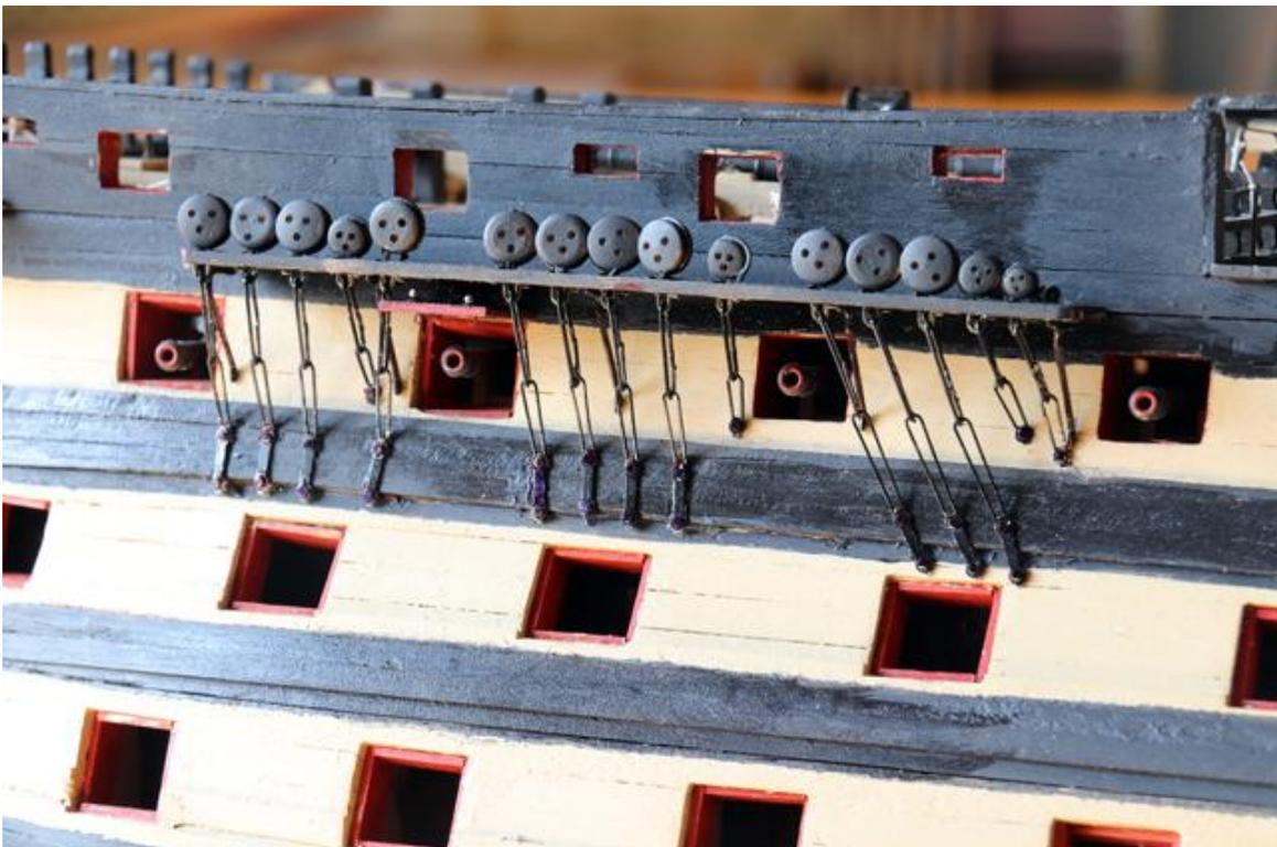
Abbildung 344: Komplette Vordere Rüste mit Püttingseisen (10.07.2023)
