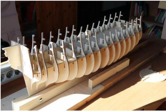
Abbildung 18: Spannten und Batteriedeck
