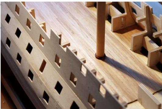
Abbildung 60: Beplanktes Batteriedeck mit Großmasttaschen (10.12.2020)
