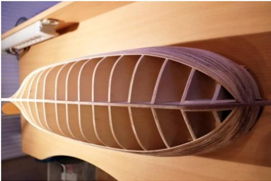
Abbildung 43: Beidseitige Beplankung (27.11.2020)
