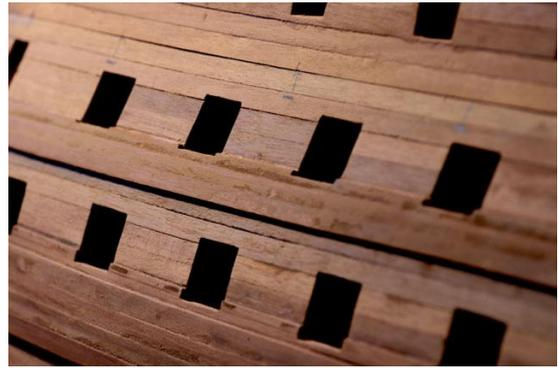
Abbildung 94: 2. Leiste des mittleren Barkholzes (18.01.2021)
