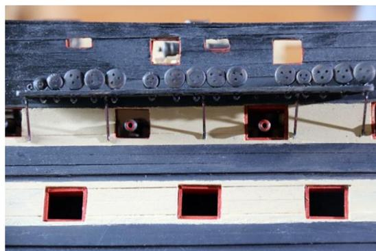
Abbildung 339: Montierte Vorderrüste mit Jungfern (04.07.2023)
